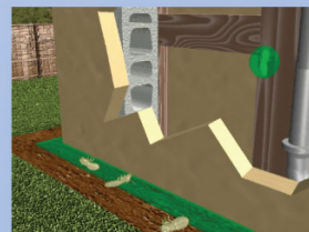
(5) 暴露于处理区的白蚁死亡后，处理区仍然起作用，并且在很长的一段时间内继续保护建筑物免受白蚁侵害。
